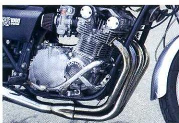
▲軽量化のため、キックスターを廃した1000のエンジン。カムカバーの飾り蓋(ふた)は、750のアルミ製に対し、スチール製のクロームメッキ仕上げのものが採用されていた。ちなみに'79年式より、シリンダーとヘッドが設計変更を受け、さらに耐久性が向上している。
