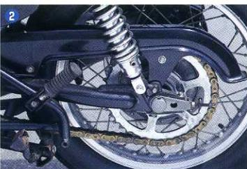
▲①②GS1000は、キャリバーが異なり、2ピースのものとなっている。加えて同年式の750は、マスターとキャリバー間がバイス&ホースの接続なのに対し、1000ではホース接続となっているため、コントローラブルだ。チェーンもRKと共同開発のブッシュチェーンを採用していた。サイズは630。なお、タンデムステップは同年代のスズキ車に共通する仕様だが、'79年式よりクッション型が高い角形のものへと変更を受けている。
