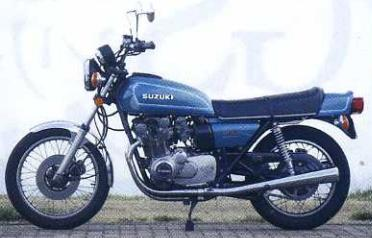
▲外装が北米仕様の縁がかった青に変更されている以外はノーマルの2型。この年式から、フロントのディスクブレーキがダブルになっている。なお、GS750のフロントフォークは35mm径を採用している。
