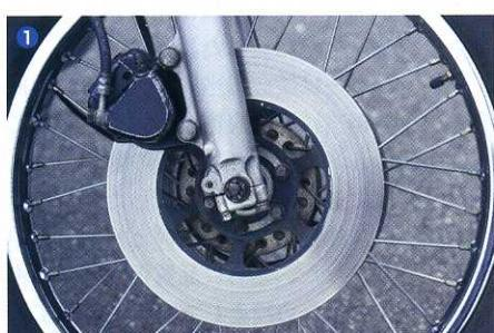
◀①②前作GT750の組み立て式から、一体式の片押しキャリバーに変更となったブレーキマウリ。77年式の1型は、フロントが軽量化のため車体左側のみのシングルディスクだったが、2型よりダブルとなった。ディスク板も2型よりそれまでの組み立て式から一体式へと変更になった。余談だが、輸出仕様のGS1000に採用されていたリヤディスクは、モデル末期まで組み立て式のプレートを使っていた。
